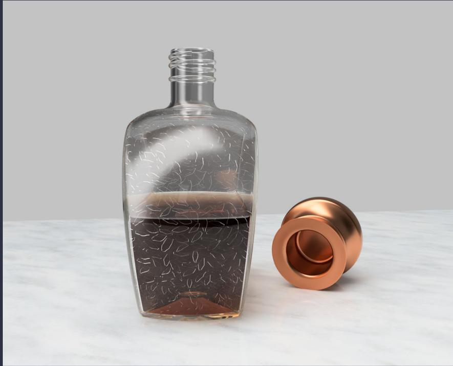
Lors de la fabrication de la bouteille, les gravures internes sont formées dans le moule ébaucheur. La forme extérieure de la bouteille est formée par soufflage dans le moule finisseur.
